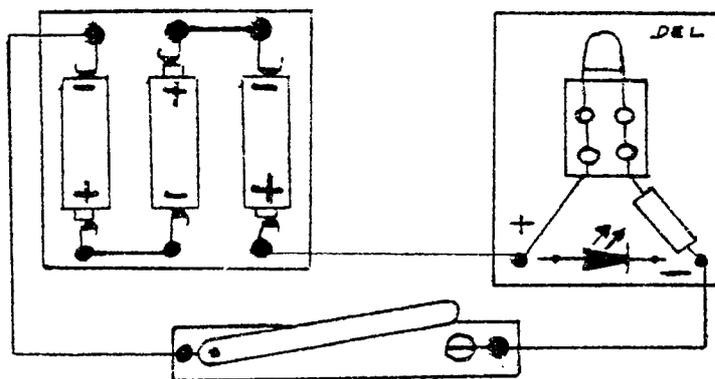
Peux-tu allumer et éteindre la DEL en manoeuvrant l'interrupteur?
