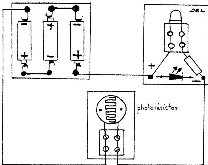
Le photorésistor n'est pas un élément polarisé:c'est à dire qu'il n'y a pas d'ordre de branchement des électrodes.
