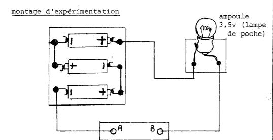
Les points "A" et "B" sont des vis (diamètre de 3 ou 4mm, longueur 25 à 35mm) maintenus par des écrous dans une petite plaquette de contreplaqué.
