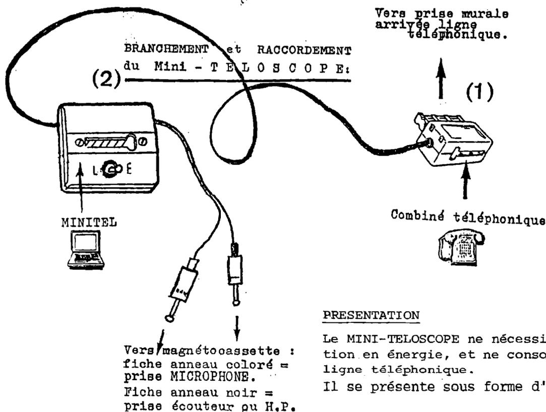
TELEPHONIQUE à relier à l'arrivée de la ligne murale, et d'un BOITIER (2) muni d'un inverseur ENREGISTREMENT/LECTURE, sur lequel se raccordent le MINITEL et le MAGNETOCASSETTE AUDIO. Une longueur de cordon d'environ 3 mètres sépare le boîtier de la prise gîgogne sur laquelle se branche le combiné téléphonique (ne plus le raccorder sur la prise du MINITEL).
