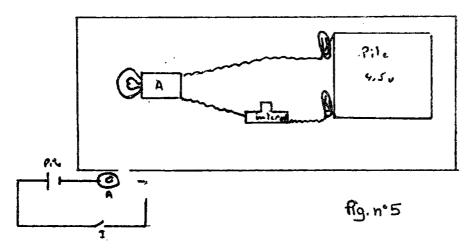
Schéma théorique et plan de câblage du système d'éclairage par pile (voir description page précédente).
