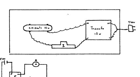
Ci-contre le schéma théorique et le plan de câblage du système d'alimentation de l'éclairage par le secteur à travers un transformateur incorporé. c) alimentation par secteur avec transfo. extérieur 12 volts.
