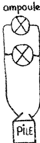
Réalise ce montage avec deux ampoules.
