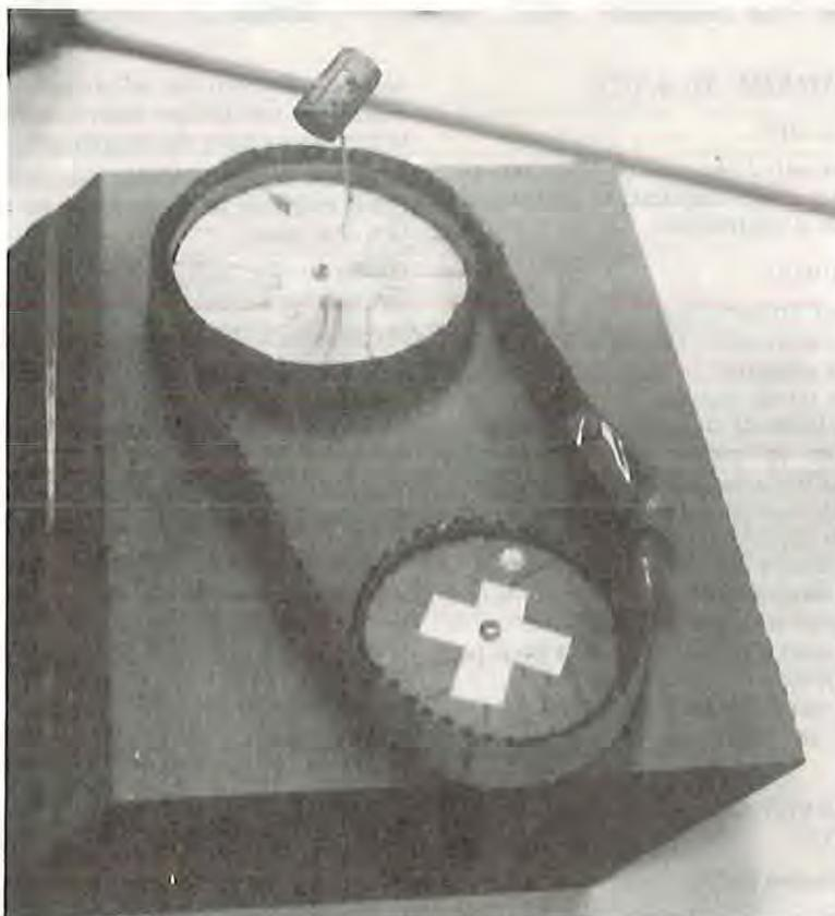
faut prendre une grande et une petite roue dentée pour que le montage ressemble à celui du vélo. Mais avec deux grandes roues, ils s'aperçoivent que le système fonctionne aussi.
