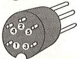
Reliez les bornes 1 et 3 de la prise téléphonique aux broches 2 et 3 de la prise DIN, en suivant les numéros figurant sur ce schéma.
