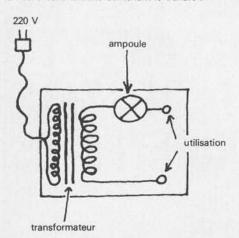
yous disposez d'un transfo donnant 12 V 3 A, l'ampoule qui sert de «fusible automatique» est une ampoule de phare d'auto.
