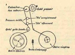
Cabestan: pièce métallique de circonférence adéquate, entraînée par le moteur du tourne-disque et assurant le déroulement du ruban à la vitesse requise.
