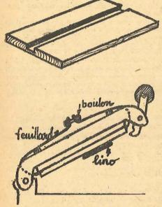
Procurez-vous une planchette de bois tendre (peuplier, sapin, etc...) du format de vos feuilles à imprimer et d'une épaisseur de 8 à 10 mm. (ou plus). Sur une face, dans le sens de la longueur, creusez une rainure de de 2 à 3 mm. de profondeur, et dont la largeur sera celle du feuillard destiné à y être introduit.
