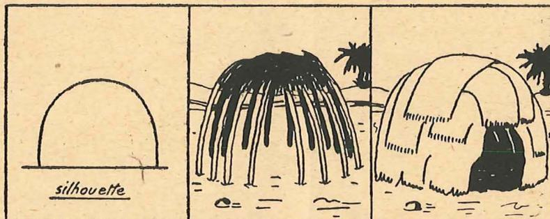
La tente en coupole comprend une armature faite de perches que l'on enfonce dans le sol, les extrémités supérieures sont courbées en forme d'arceaux. Sur cette armature, on étend des nattes faites de fourrage sec, ou encore des couvertures.
