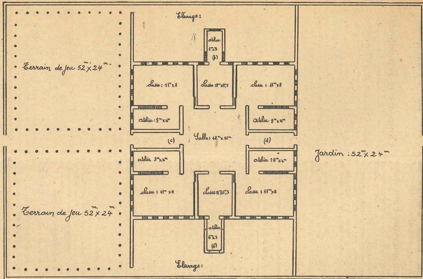
PLAN D'UNE ECOLE DE PLUS DE TROIS CLASSES. — Le plafond des salles (a) et (b) et des corridors (c) et (d) est à 3 mètres de hauteur afin de pouvoir établir des fenêtres ouvrant sur les terrasses. Le plafond des autres salles est à 4 mètres de hauteur.
