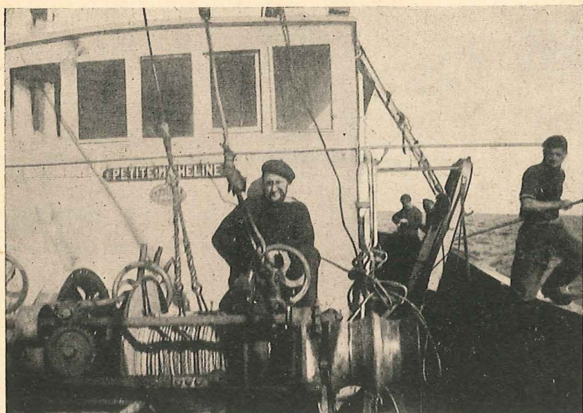
Vue du treuil et de la passerelle
