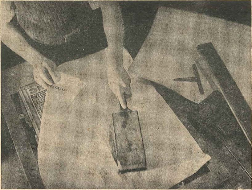
Un ouvrier tire une « morasse » (à droite, une « galée » posée sur un « flan ») (Photo "Liberté de l'Est")
