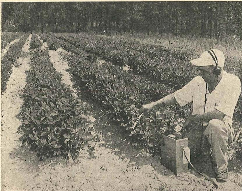
Après que les produits radioactifs contenus dans l'engrais ont été absorbés par la plante, un compteur détecte la quantité et le rythme de l'assimilation
