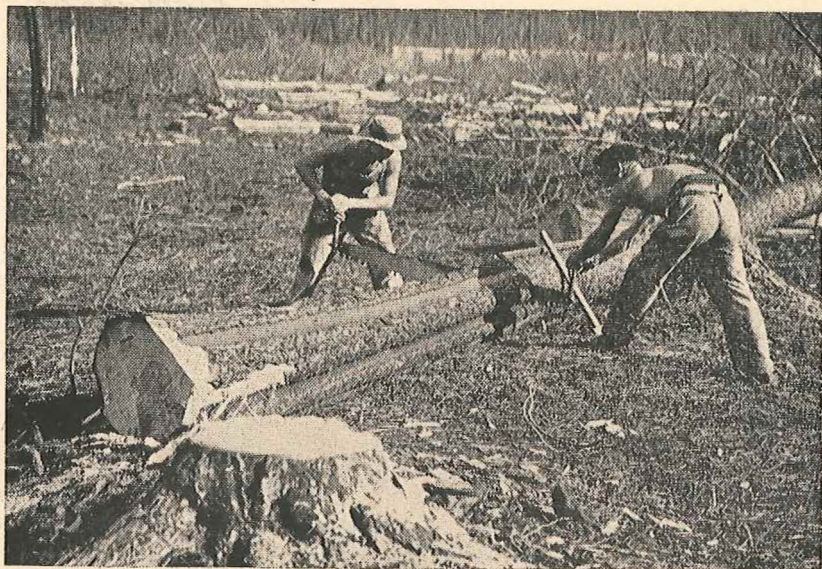
Le tronçonnage se fait au passe-partout ou avec la scie à moteur
